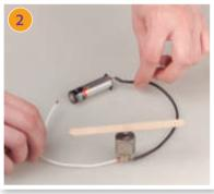
Conecten los cables a los terminales del motor. Luego, con la cinta adhesiva conecten el extremo de uno de ellos a la pila (observen la imagen).
