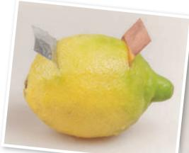
Insertaron en unos limones dos láminas, una de latón y otra de cobre, tal como se muestra en la imagen.
